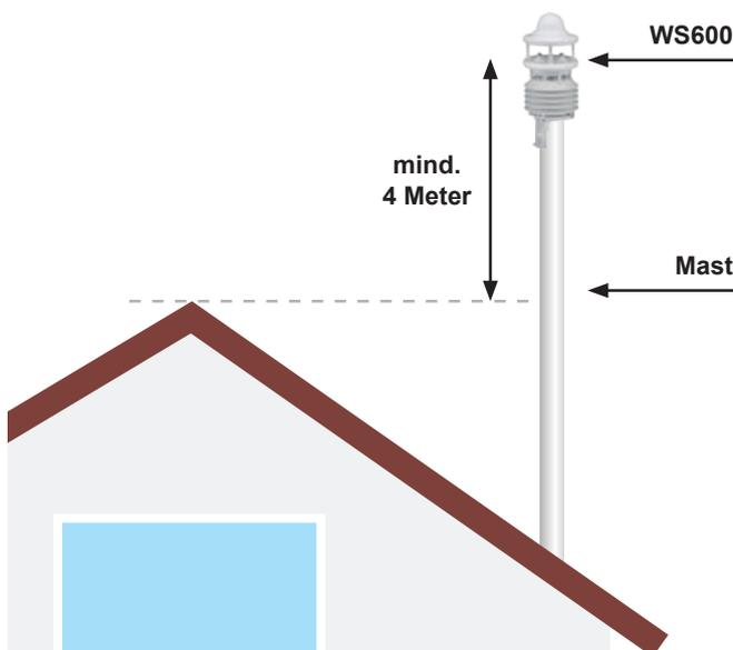
**Um genaue Messwerte zu erhalten, muss bei der Installation der Wetterstation auf ein paar Dinge geachtet werden:**
